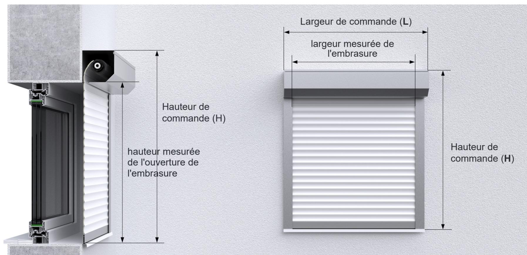
Le caisson de volet roulant est monté sur le mur au-dessus de l'ouverture de la fenêtre, les rails de guidage à gauche et à droite.
