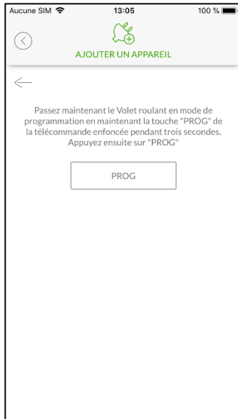
Mettez le lecteur en mode apprentissage en appuyant sur le bouton de programmation pendant 3 secondes, puis appuyez sur "PROG" dans l'application.
