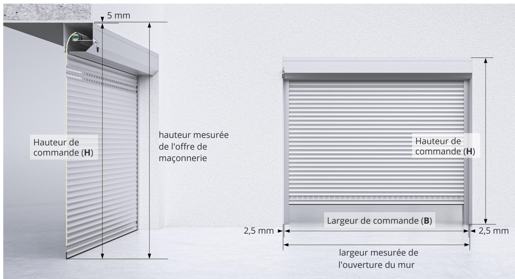
Le caisson de volet roulant ainsi que les rails de guidage sont montés à l'intérieur de l'offre murale.
