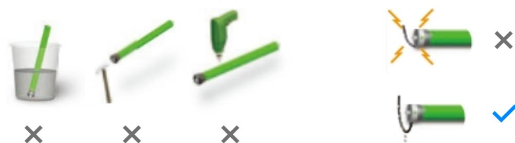
Pour éviter les infiltrations d'eau, le câble doit être posé comme sur l'image pendant le montage.
